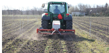
Billede 16 og 17. Forsøg med mekanisk ukrudtsbekæmpelse i pil ved Tylstrup, 2012. Den anvendte rækkefræser kan fræse over en dobbeltrække. Der er desuden mulighed for at placere gødning i planterækken. Fotograferet ved den første fræsning, udført den 30/3 2012. (Foto: Søren Ugilt Larsen, AgroTech).
