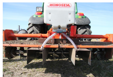
Billede 16 og 17. Forsøg med mekanisk ukrudtsbekæmpelse i pil ved Tylstrup, 2012. Den anvendte rækkefræser kan fræse over en dobbeltrække. Der er desuden mulighed for at placere gødning i planterækken. Fotograferet ved den første fræsning, udført den 30/3 2012. (Foto: Søren Ugilt Larsen, AgroTech).
